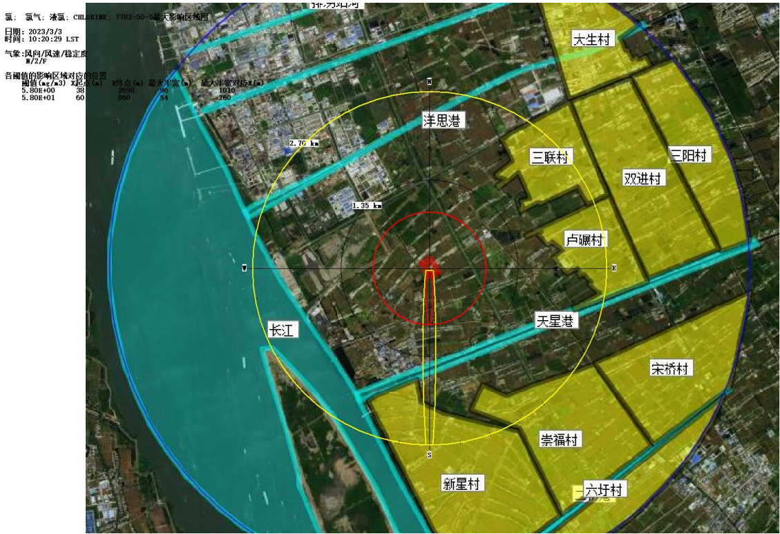
图 5.8-1 液氯扩散最大影响区域图（最不利气象）
