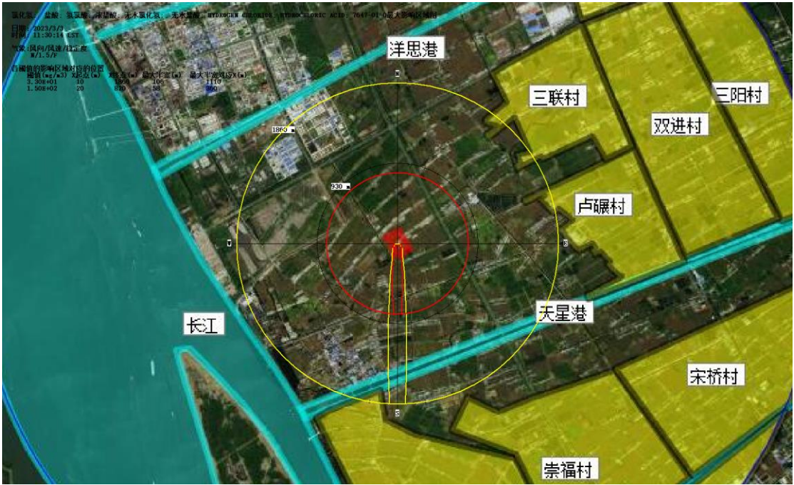
图 5.8-3 氯化氢扩散最大影响区域图（最不利气象）
